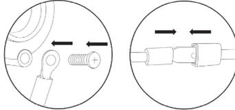
2. **Modelo H3** - Coloque el anillo de cable de cátodo en el agujero usando el tornillo original.
