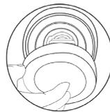
2. Conecte la caja de control al enchufe original. Utilice una cinta adhesiva de doble cara para fijar las cajas de control. Instale el guardapolvo de nuevo.
