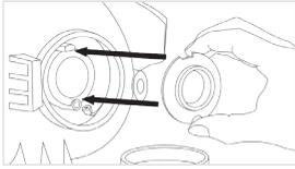
1. Quite el guardapolvo y la lámpara original. Quite la base LED y colóquela en lugar de la lámpara original. Use un destornillador para instalar la base LED. En el caso del modelo H1 insértela en el agujero y fíjela con el circlip original.
