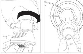
1. Gire el soporte de la lámpara LED en sentido contrario a las agujas del reloj para quitar la parte superior. Instale la lámpara LED M-TECH en el casquillo.
