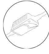
3. Utilice una cinta adhesiva de doble cara para fijar las cajas de control. Instale el guardapolvo de nuevo.
