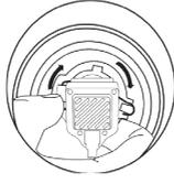
2. Inserte la base de la lámpara con el radiador. Gire en el sentido de las manecillas del reloj y asegúrese si queda bien. Conecte la caja de control al enchufe original.
