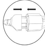
3. Conecte la caja de control al enchufe original, utilice una brida de plástico o una cinta adhesiva de doble cara para fijar las cajas de control.
