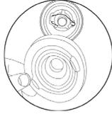
2. Instale el guardapolvo e inserte la base de la lámpara con el radiador. Gire en el sentido de las manecillas del reloj y asegúrese si queda bien.
